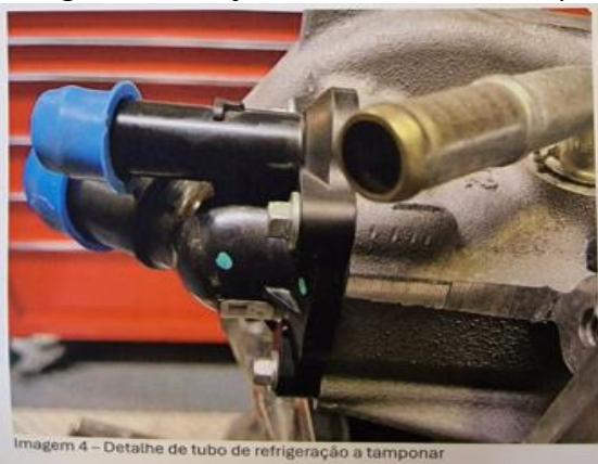
Imagem 4 – Detalhe de tubo de refrigeração a tamponar
